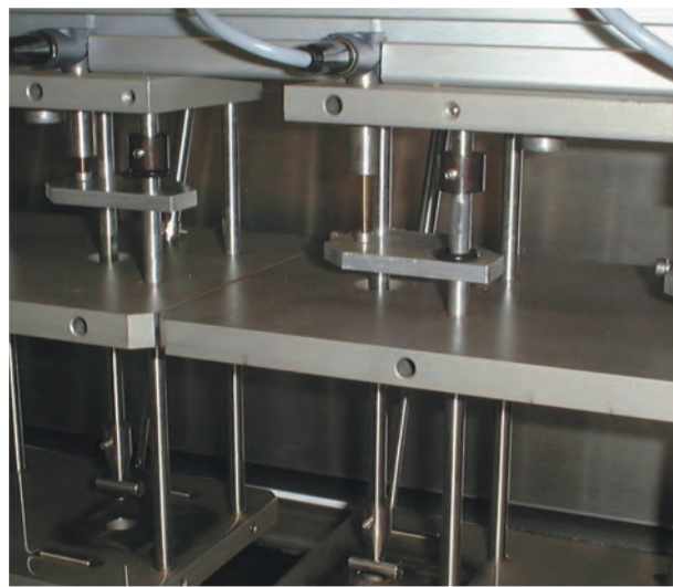
Messkopf: In ihm befinden sich die Temperaturmessrichtung und der Wegsensor.
